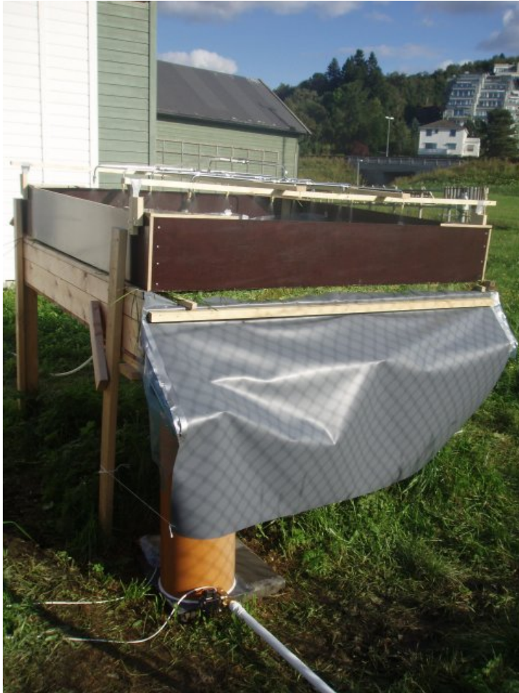
Figur 13 Nittedals Taktorv ® påmontert dyserigg.
